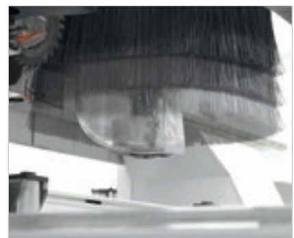
CNC-gesteuertes Späneleitsystem (Späneleitblech).
