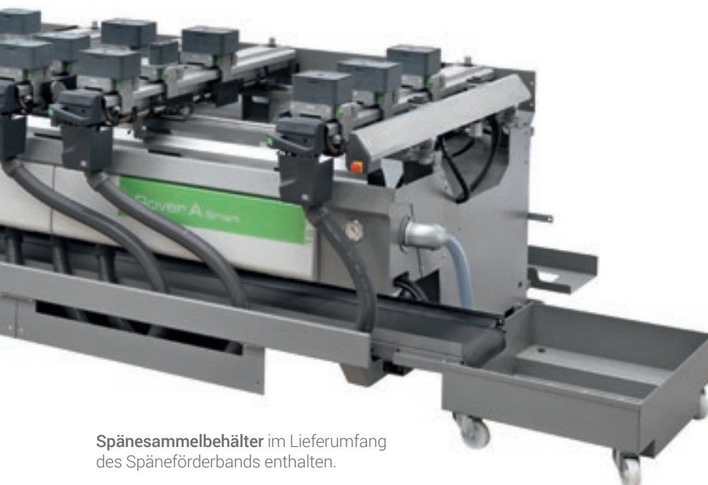
CNC-gesteuertes Späneleitsystem (Späneleitblech).
